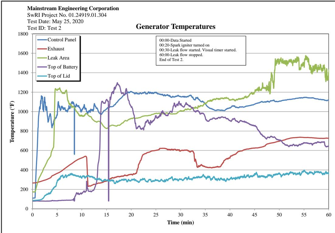
**Figure C-5. Test 2: Generator Temperatures.**
