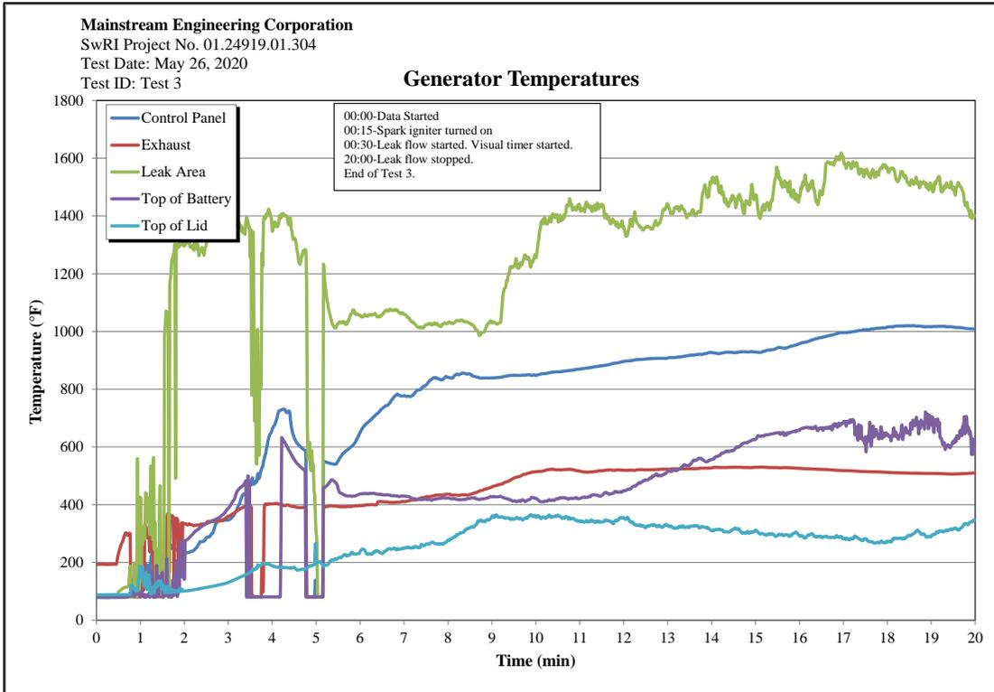
**Figure C-9. Test 3: Generator Temperatures.**
