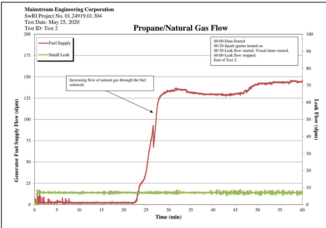
**Figure C-8. Test 2: Gas Flow Rates.**
