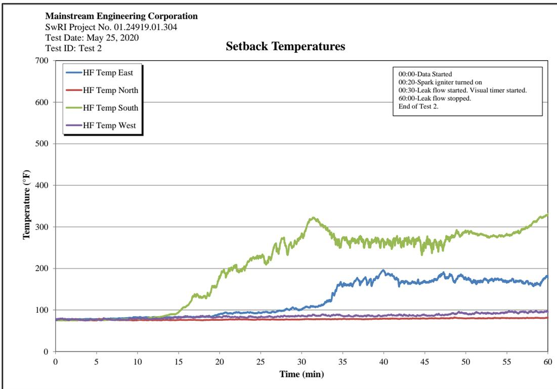
**Figure C-6. Test 2: Setback Temperatures.**
